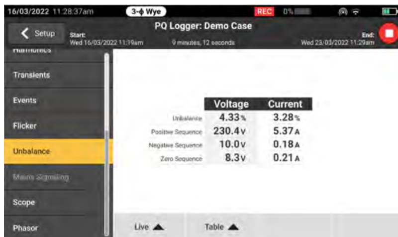
Bild 3: Tabelle der unsymmetrischen Spannungen und Ströme, die mit dem Fluke 1777 erfasst wurden
