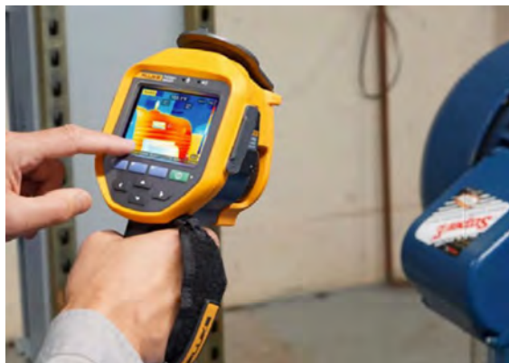
Wärmebildkamera Fluke Ti480 Pro bei Motorinspektionen
