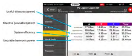
Bild 4: Nutzbare und unbrauchbare Leistung, die mit dem Fluke 1777 erfasst wurde
